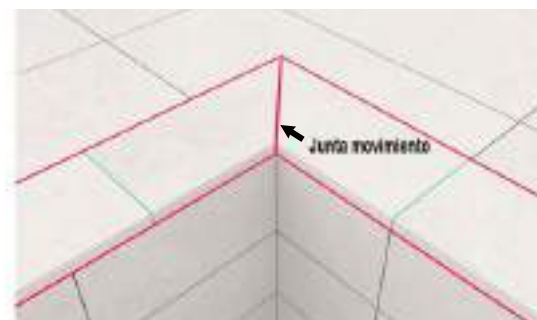
Junta de movimiento marcada en rojo en las esquinas de la piscina.
